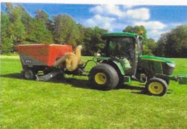
Vertikalskärning med skärare och sugvagn
